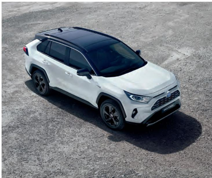
stata compromessa in alcun modo dal nuovo design. Infatti il nuovo modello con i suoi 4.600 mm di lunghezza è di poco inferiore rispetto al modello uscente. Nonostante la riduzione dello sbalzo anteriore e posteriore, l'allungamento di 30 mm del passo ha consen-
