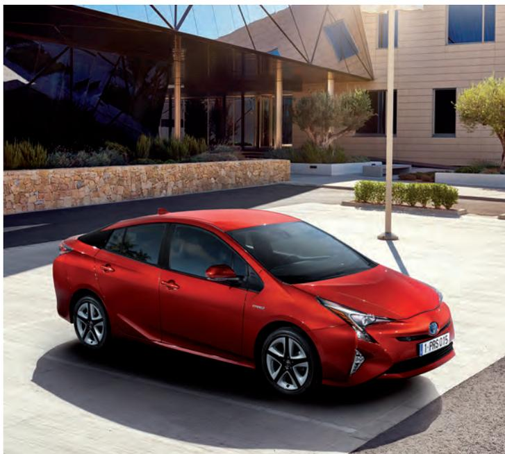
coefficiente di resistenza aerodinamica (valore *cx*) da un modello all'altro è passato da 0,25 a 0,24. La struttura e il sottoscocca sono stati perfezionati in modo da consentire il miglior flusso d'aria possibile sopra, sotto e dietro la vettura, ciò che sfocia in un'ulteriore riduzione dei consumi.
